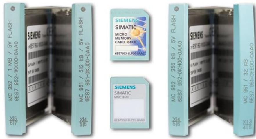
CPU های قدیمی دارای Load Memory (فضای ذخیره برنامه کاربر) به صورت RAM داخلی بودند، از این رو برای حفظ برنامه داخل این حافظه در زمان قطع شدن تغذیه، از باتری پشتیبان استفاده می شد. این باتری به دلیل اینکه در CPU های جدید، حافظه Load Memory به صورت خارجی و در قالب فلاش ارائه می شود، حذف شده است.
