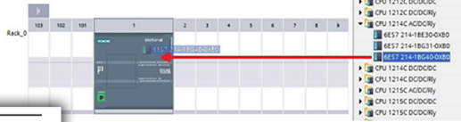
شکل ۲۷۹ وارد کردن CPU در رک
