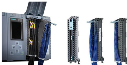
شکل ۲۸۷ سیم کشی به کارت های ورودی و خروجی
