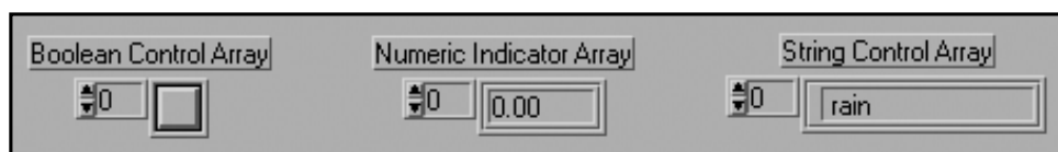
شکل ۷-۳: شکل ظاهری پوسته‌ی آرایه در صفحه‌ی پانل پس از قرار دادن مؤلفه‌ها در داخل پنجره‌ی Element Display
