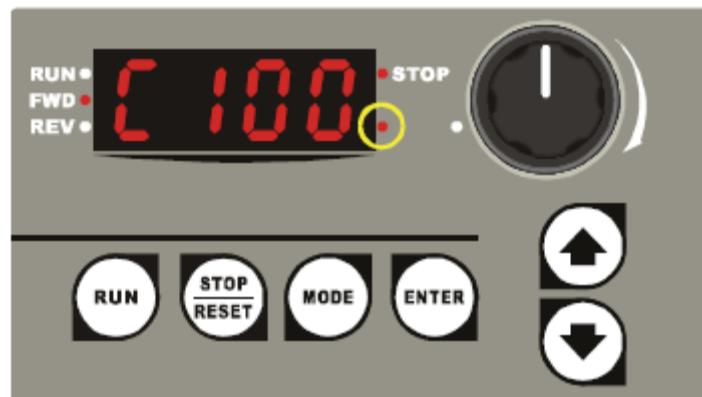
.8 نمایش می دهد: در این حالت فقط 3 رقم نمایش داده می شود و LED ی گوشه ی پایینی در سمت راست روشن می شود و یک پوینت قبل از رقم یکی مانده به آخر روشن می شود تا نشان دهد که عدد نمایش داده شده باید در 100 ضرب شود. برای مثال، مقداری که در شکل زیر نمایش داده شده است به این صورت است:
