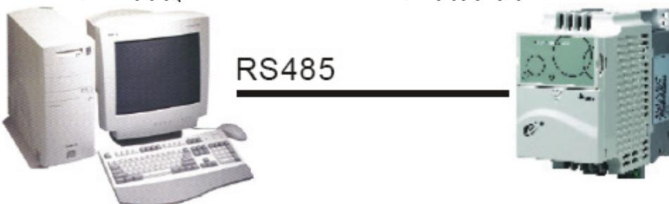
3. نصب برنامه ی PLC در درایو AC: برای برنامه ی سیم بندی به D.2 تا D.7 مراجعه کنید و ادیتور DELTA (WPLSoft) را از وب سایت [http://www.delta.com.tw/product/plc\\_software.asp](http://www.delta.com.tw/product/plc_software.asp) بگیرید.
